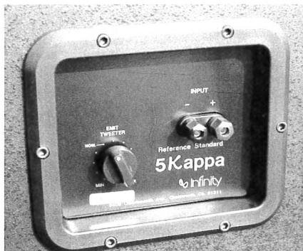
Posteriormente, accanto ai morsetti di ingresso trova posto il controllo che regola il livello di emissione del tweeter
