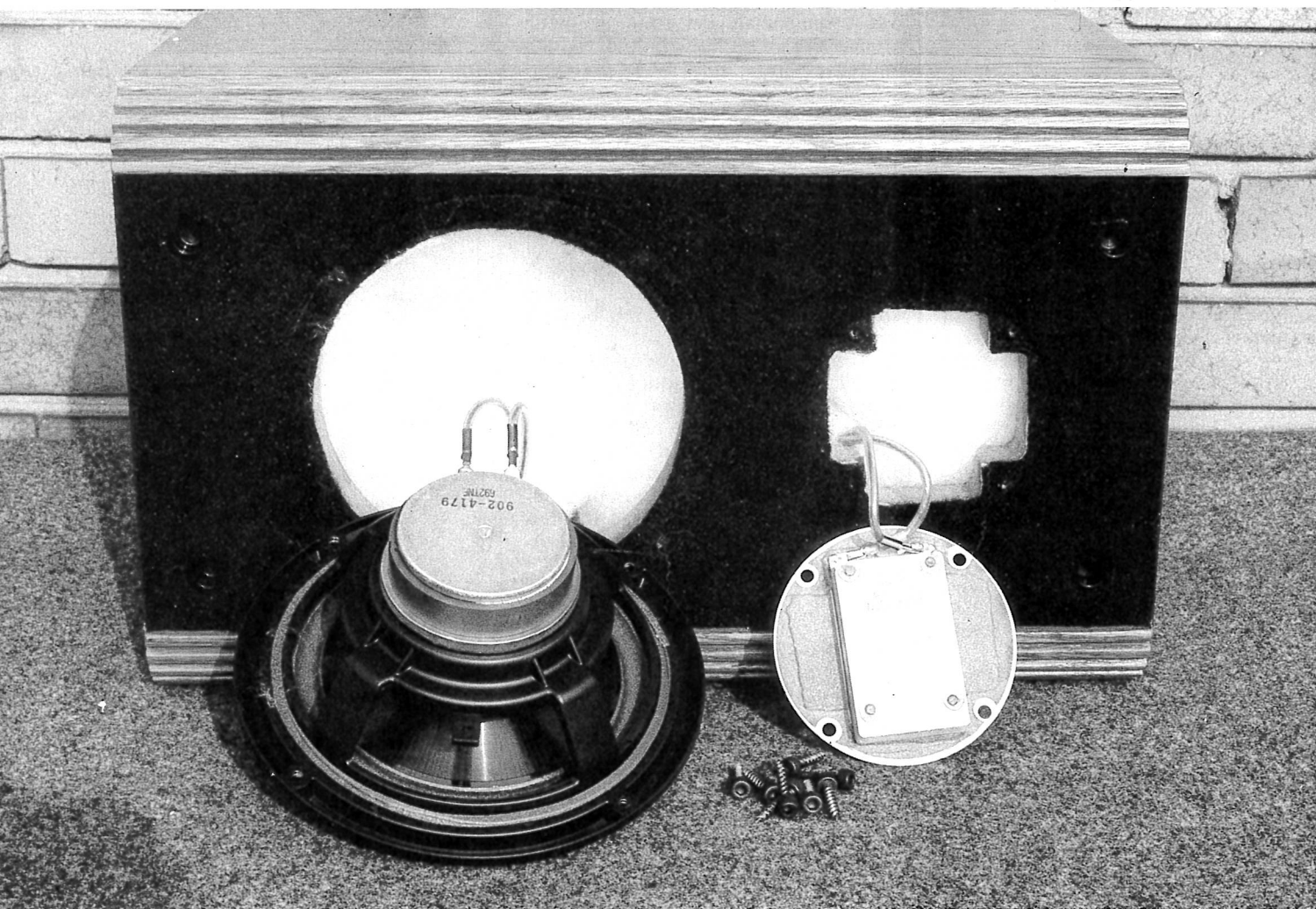
Un esploso della K 5. Si noti l'interno interamente realizzato in truciolare ad alta densità alto 18 mm, escluso il frontale il cui spessore è di ben 28 mm.
